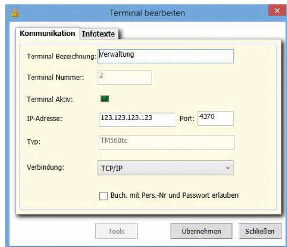
Setzen Sie den Hacken bei **Terminal Aktiv**. Vergeben Sie eine interne freie **IP-Adresse** für das Terminal, wenn Sie das Gerät mit TCP/IP nutzen möchten.
